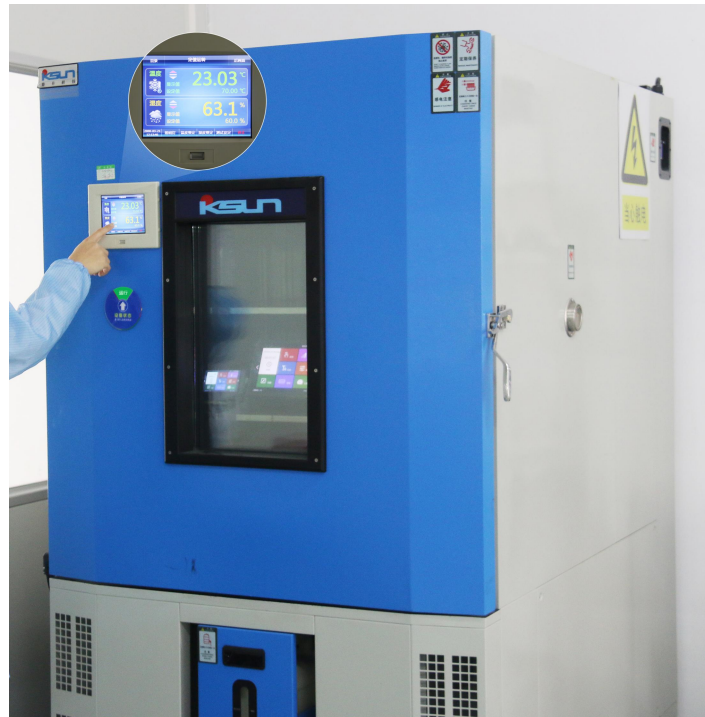
图 4-7 高低温老化测试图
